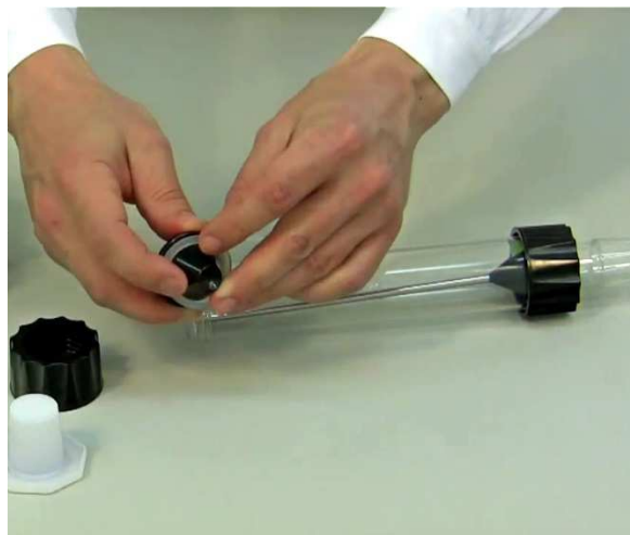
Obrázek 1-6: Teflonové těsnění nasadíme na hlavu dávkovače tak, aby směřovalo ke skleněné nádobě.
