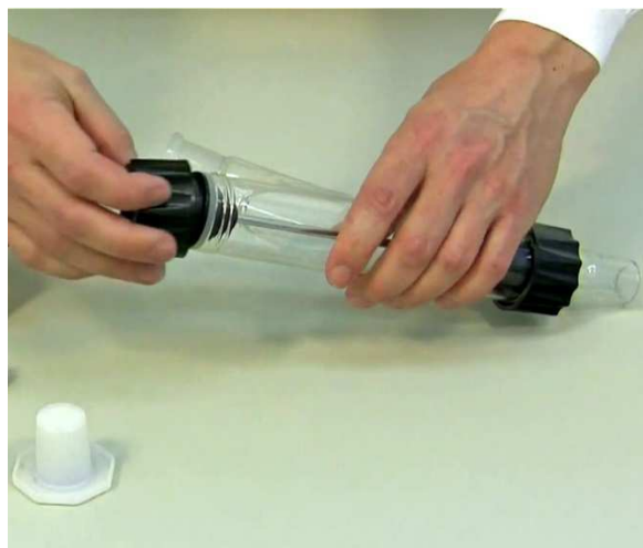
Obrázek 1-8: Šroubovací uzávěrem zajistíme hlavu dávkovače s těsněním ke skleněné nádobě.
