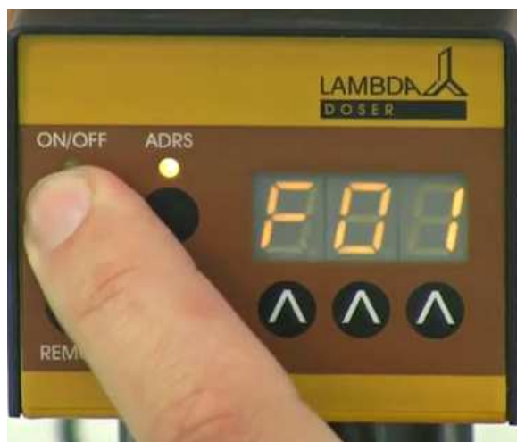
Obrázek 2-3: Stiskněte tlačítko ON/OFF . Na displeji se zobrazí na krátkou dobu označení "F01" (Flow = průtok) a následně můžeme nastavit požadovanou hodnotu průtoku (rychlosti dávkování).
