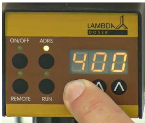
Obrázek 2-4: Pomocí tlačítek ▲▲▲ pod displejem nastavte požadovanou hodnotu průtoku pro první krok programu (od 0 do 999, což odpovídá 0 až 100 % rychlosti otáčení motoru).
