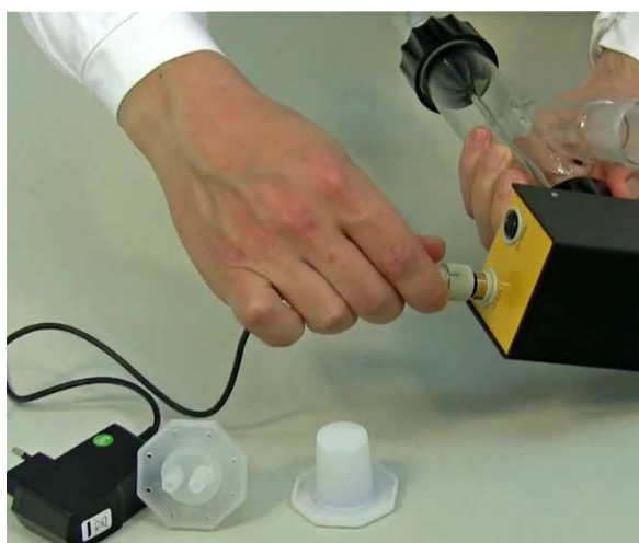
Obrázek 1-11: Kabel síťového zdroje zasuneme do odpovídající zásuvky 12 V DC pohonné jednotky a zajistíme šroubovacím kroužkem a následně zapojíme do elektrické sítě.
