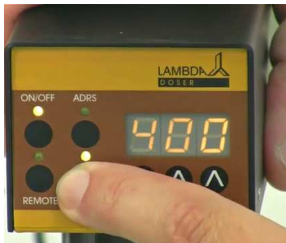
Obrázek 2-16: Program se odstartuje stisknutím tlačítka RUN . Svítí LED diody RUN a ON/OFF .
