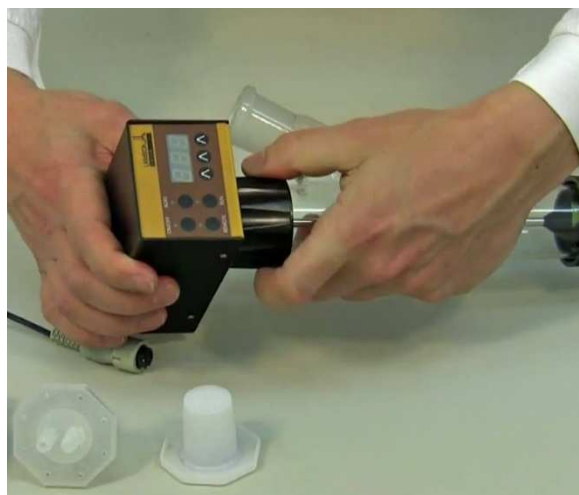
Obrázek 1-10: Zatlačíme pohonnou jednotku do hlavy dávkovače, až na doraz čímž se zajistí utěsnění dávkovače a přitlačení spodní části distributoru proti teflonovému těsnění ve spodní části nádoby dávkovače. Po lehkém povolení horního šroubovacího uzávěru lze nastavit vhodnou polohu pohonné jednotky vzhledem k plnicímu hrdlu nádoby. Po nastavení požadované pozice znovu utáhněte.
