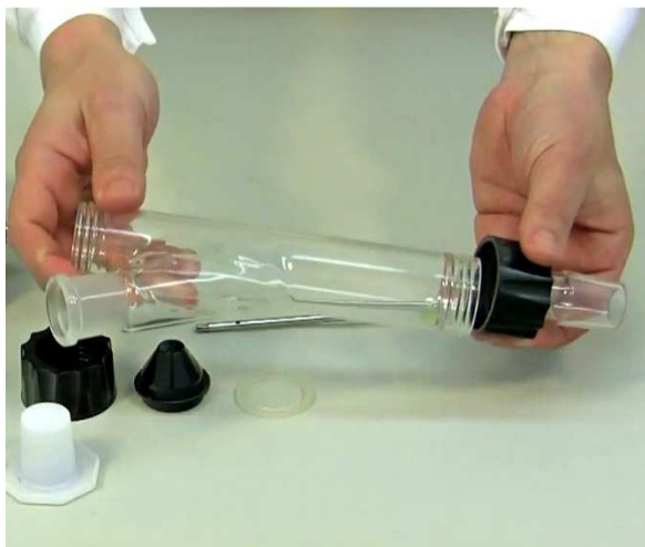
Obrázek 1-3: Šroubovací uzávěr spolu s teflonovou podložkou a skleněným adaptérem přišroubujeme na spodní část skleněné dávkovací nádoby s jedním bočním ramenem.
