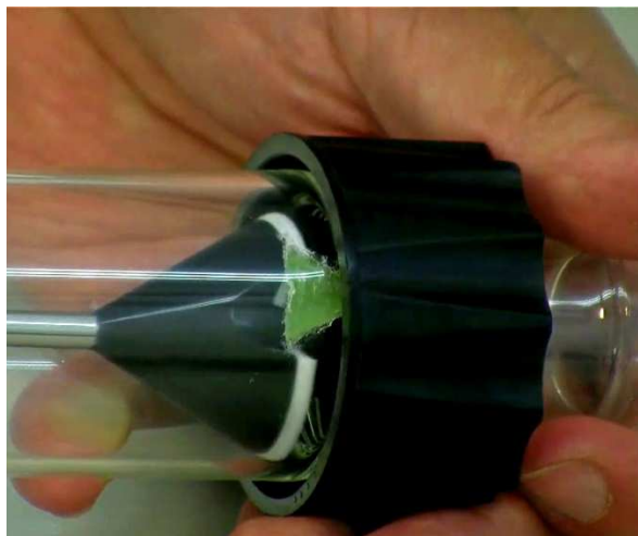
Obrázek 1-5: V dolní části nádoby je nalepená silikonová přepážka. Při zasouvání je třeba rozdělovač natočit tak, aby jeho výřez směřoval proti přepážce.
