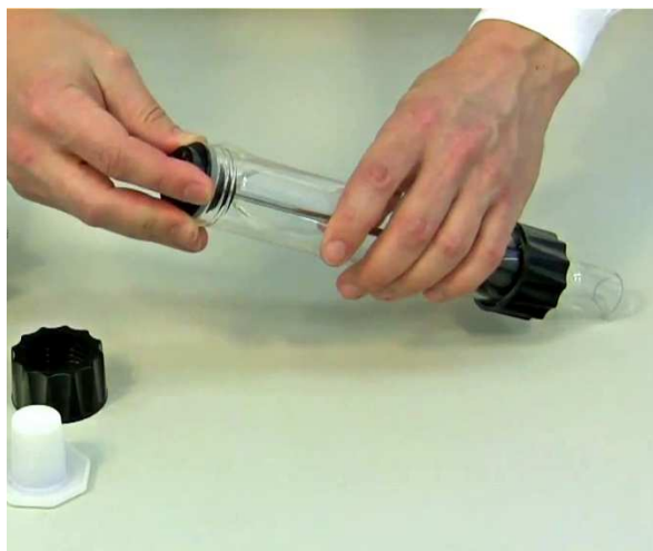
Obrázek 1-7: Umístíme středící díl s těsněním na osu distributoru.
