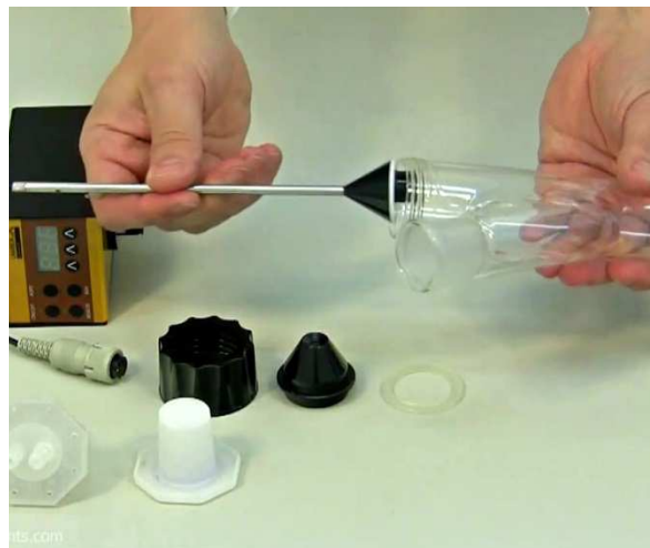
Obrázek 1-4: Distributor (rozdělovač) vložíme opatrně shora do skleněné nádoby, tak aby výřez rozdělovače směřoval dolů.
