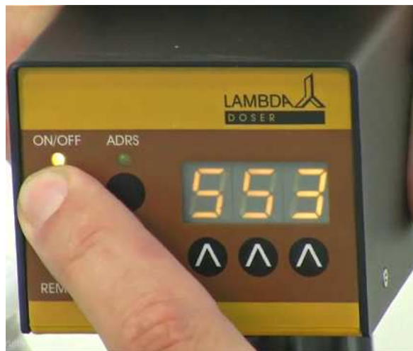
Obrázek 1-14: Potvrzení zvolené rychlosti dávkování stiskem tlačítka ON/OFF .
