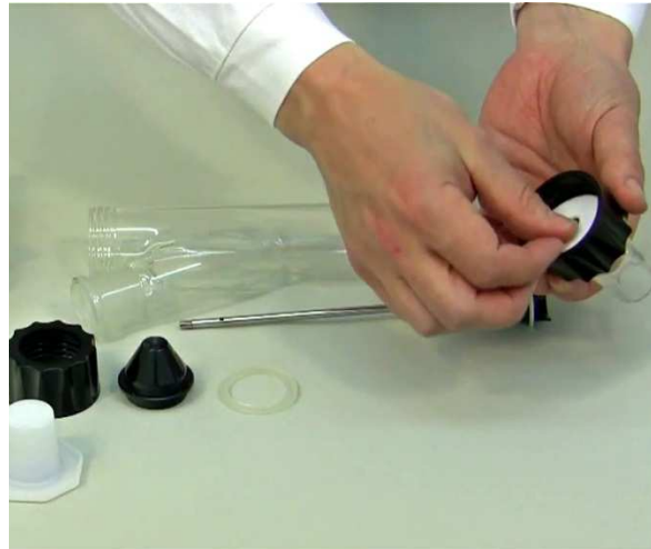
Obrázek 1-2: Teflonovou podložku položíme na plochý zábrus, který je provlečený přes šroubovací uzávěr.
