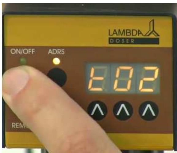
Obrázek 2-9: Pro potvrzení stiskněte opět tlačítko ON/OFF . Na displeji se zobrazí "t02".
