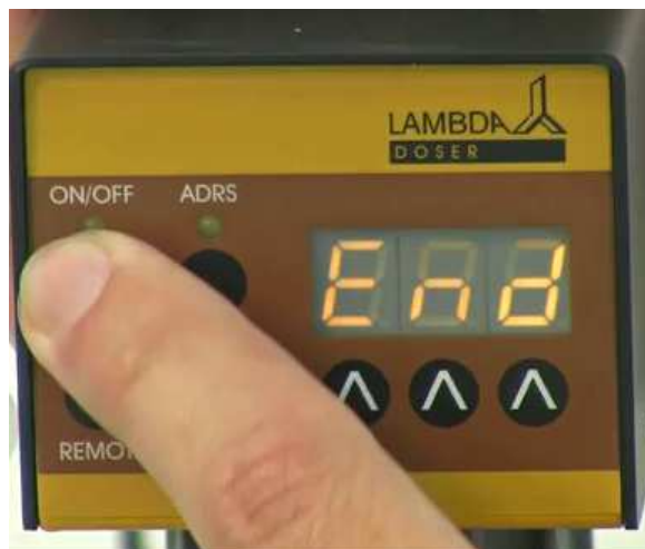
Obrázek 2-15: Stiskněte znovu tlačítko ON/OFF pro potvrzení a uložení programu. Na displeji se zobrazí “End” .
